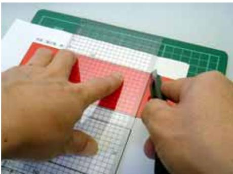
塩ビ板 (赤) を図面に合わせカットします
