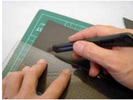
ポリプロピレン（黒）にピンで印を付け、カッターでカットします
