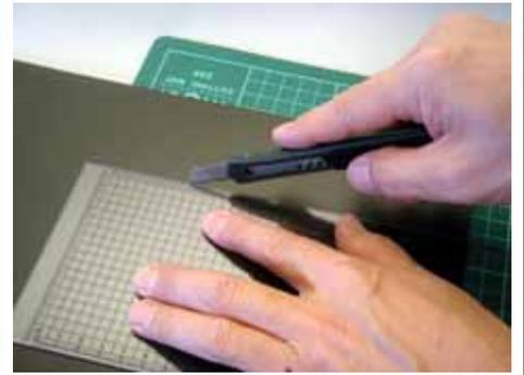
図面を切り取り、ポリプロピレン（黒）にピンで印を付けます
